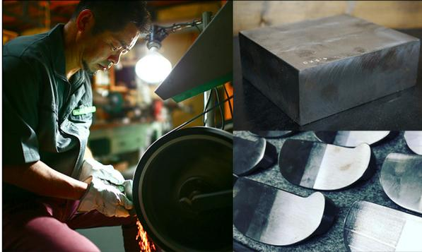
パター素材として最適な軟鉄素材の塊（インゴット）を CNC 機械加工によって削り出し、熟練工による手作業によって、形状を整えるハンドメイドパターです。
